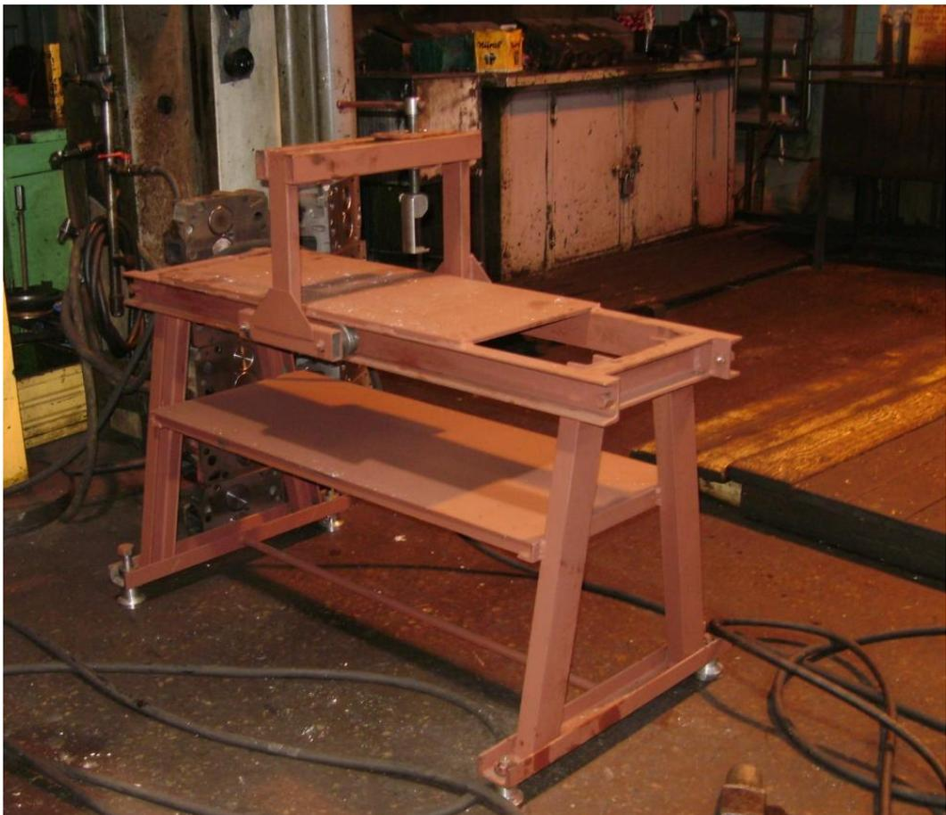
Рис. 2. Приспособление для рассухаривания клапанов двигателя *Cummins*
